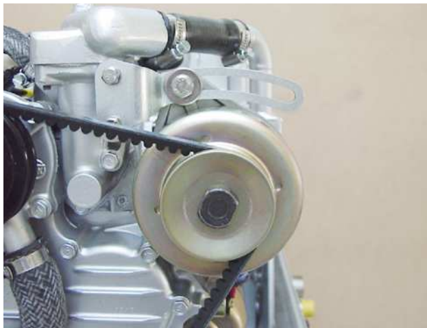
Fig. A.3.5-7: DC-alternator
